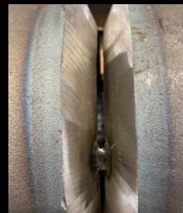
Svařování otevřeného kořene s mezerou 3 mm a bez podložky
